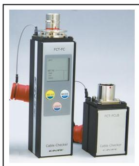
L'appareil de test FCT-FCKIT Red permet de tester très facilement tous les câbles de camera SMPTE 311. Il est équipé de connecteurs compatibles SMPTE 304. Il permet de mesurer le taux d'atténuation des fibres optiques ainsi que la continuité ou les courts-circuits des liaisons cuivres (Power et signal contrôle).
